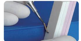
スケーラーのブレードを水平に固定し、シャープナーの平行を保ちながら軽く短いストロークで上下に動かす。
