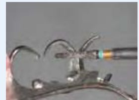
技工用ハンドピースを使用し、デンチャーのクラスプ内面等の調整。(30,000rpm以下で使用)
