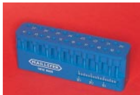
図2 メジャリングゲージ。エンジンにLight Speedを付けて、0.5mm刻みの長さが設定されたホールに入れると所望の長さでストッパが止まる
