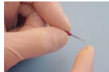
図6 その他のニッケルチタンファイルにみられない優れた超弾性を示す
