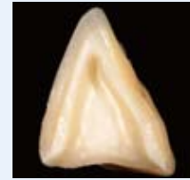
オールセラミックスクラウン切 断面。チッピングはほぼなく、 鋭利な断面である
